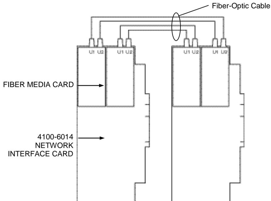
**Figure 4-6. Fiber Wiring**
