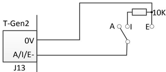
Fig 3.3C Auto/Isolate (Disable) / Evacuate Input
