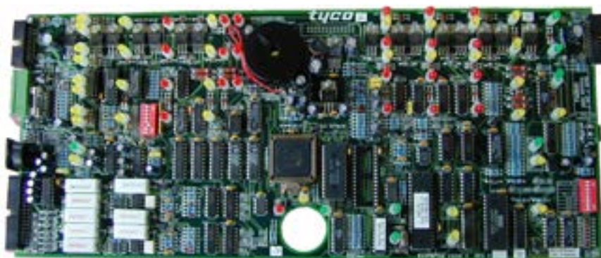
PA0643 ECP9702-1 3 WIP/Zone Control Module
