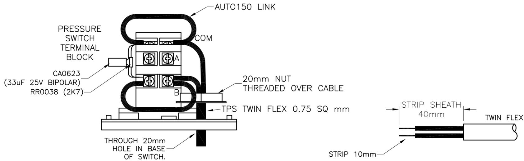
INSIDE VIEW OF SYSTEM SENSOR PRESSURE SWITCH (SW0154).
